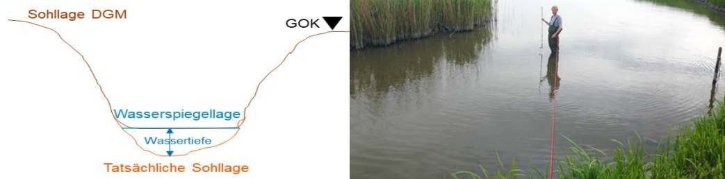
Abbildung 5.2: Skizze zu den zu messenden Werten der Wassertiefe und Gewässerbreite auf Höhe der der Gewässeroberfläche (links) und Umsetzung vor Ort (rechts, Quelle: WWF)
